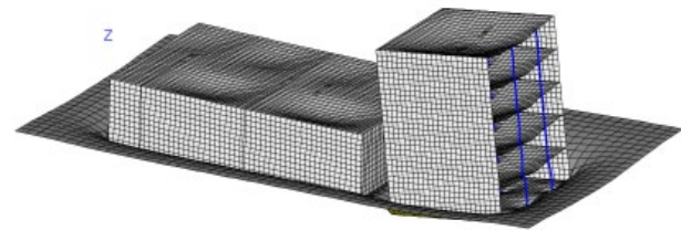
Untersuchung von Mitnahmesetzungen benachbarter Bauwerke
