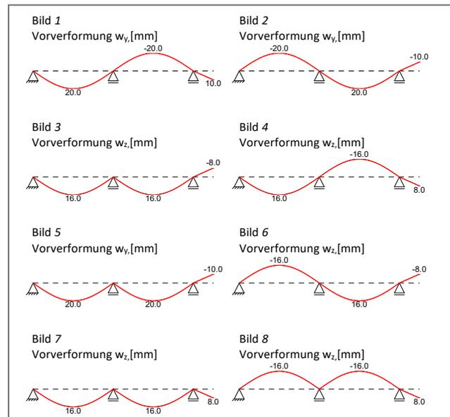
Bild 4. Bei Zweifeldträger mit Doppelbiegung untersuchte Imperfektionen
