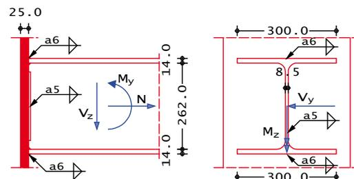
S722.de **Stahl-Normalkraftanschluss, Knotenblechanschluss**
