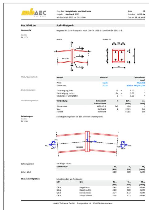
S705.de **Stahl-Stirnplattenstoß, Komponentenmethode**
