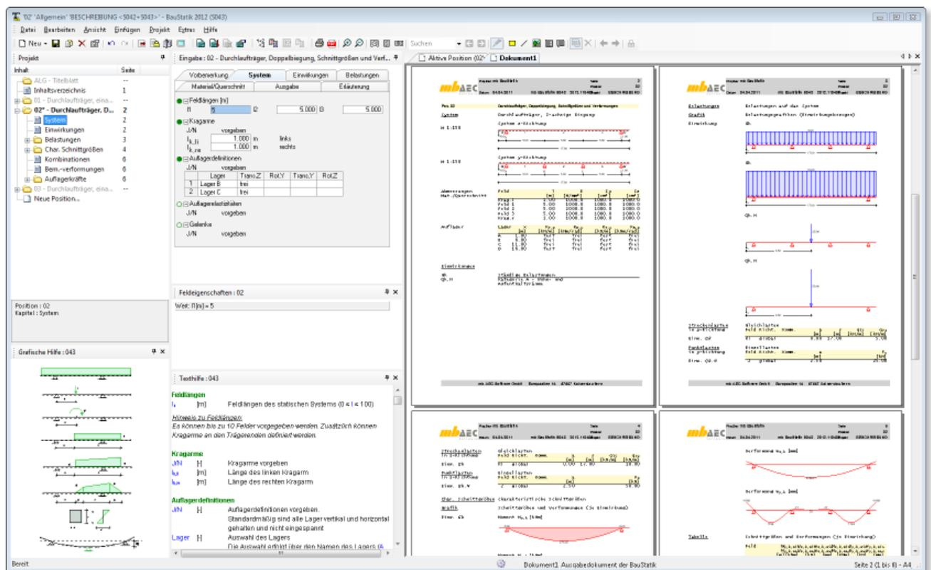
Die Module S042 und S043 berechnen Schnittgrößen und Verformungen für beliebige Einfeld- und Durchlaufträgersysteme mit und ohne Kragarm. Dabei ist das Modul S042 speziell für eine einachsige, vertikale Belastung ausgelegt, während das Modul S043 die Berechnung von Systemen mit zweiachsiger Biegebeanspruchung ermöglicht.
