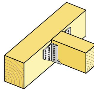
Bild 7. Balkenschuh-Anschluss
