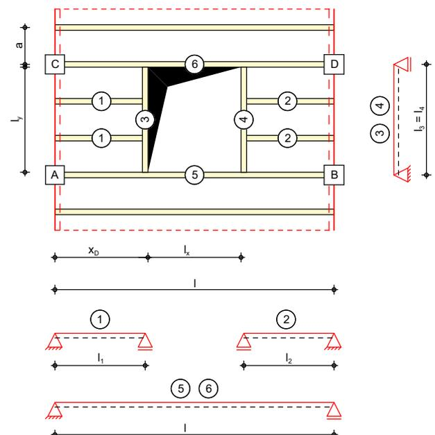
Bild 3. Statische Systeme des Deckenwechsels am Beispiel des Positionstyps „Einfeldträger“ und des Öffnungstyps „Deckenmitte“
