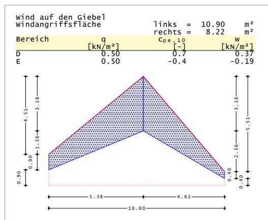
Aus der Windlast auf den Giebel und, sofern zu berücksichtigen, den anteiligen Seitenlasten aus den Sparren ergibt sich eine Horizontalkraft, die als Zugkraft im Windrispenband abgetragen wird.
