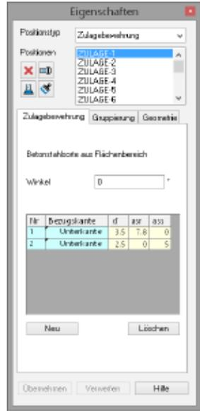
Bild 10. Definition einer Zulagebewehrung
