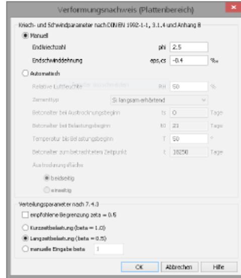
Bild 6. Parameter zur Verformungsberechnung
