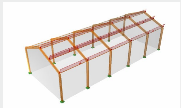
f) Druck auf luv-Dachfläche, verteilt auf Pfetten
