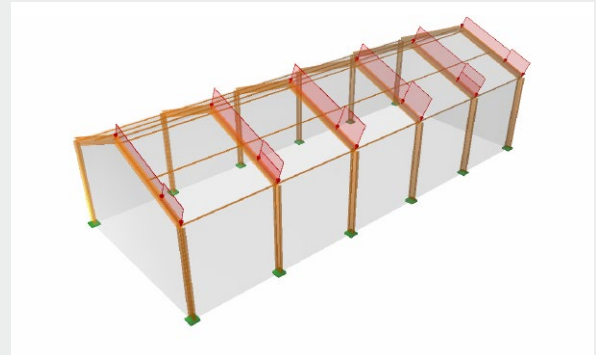
d) Druck auf luv-Dachfläche, verteilt auf Rahmen
