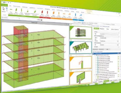
Der StrukturEditor verbindet auf eine beeindruckende Art und Weise die klassischen und etablierten Bearbeitungsmethoden der Tragwerksplanung mit der zukünftigen Arbeitsweise nach der BIM-Methode. Das komplette Tragwerk wird als Systemlinienmodell abgebildet. Dieses steht im Projekt als Grundlage für alle Nachweise, Lastermittlungen und Auswertungen zur Verfügung.
