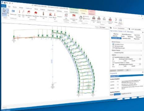
EuroSta dient der Berechnung und Bemessung von ebenen und räumlichen Stabtragwerken aus Holz oder Stahl. Es bietet eine effektive, grafische Bearbeitung der Tragstruktur durch die Integration von Eingabe, Statik, Nachweisen und Bemessung – einschließlich Systemknickstabilität, Eigenschwingungen und Numerik/Kinematik-Tests bis hin zur Anschlussbemessung.
