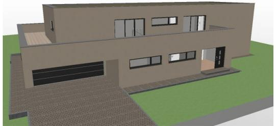
Das Architekturmodell wird in ViCADO.arc oder ViCADO.ing modelliert oder im IFC-Format aus einem anderen CAD-System importiert.
