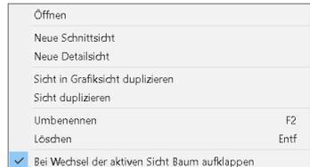
Mit einem Doppelklick im Fenster „Sichten“ auf eine vorhandene Sicht wird diese geöffnet und als neue aktive Sicht übernommen. Für diese zeigt ViCADO automatisch die Liste der verwendeten 2D-Kategorien im Fenster „Sichten“ an. Bei der Bearbeitung von z.B. Plansichten erleichtern und beschleunigen die Augen-Symbole die Bearbeitung von Planteilen. Wird dies nicht gewünscht, kann dieses Verhalten über den Eintrag „Bei Wechsel der aktiven Sicht Baum aufklappen“ deaktiviert werden.
