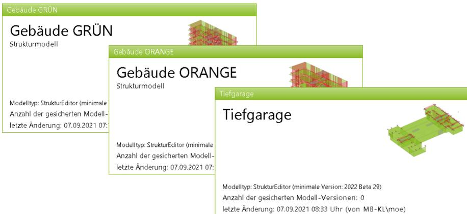
Die aufgehenden Gebäude sowie eine gemeinsame Tiefgarage können wahlweise jeweils als separate StrukturEditor-Modelle erstellt oder aus ViCADO heraus freigegeben werden. Mit dem Lastabtrag aus einem anderen Strukturmodell werden alle Lasten aus mehreren Modellen auf eins zusammengeführt.
