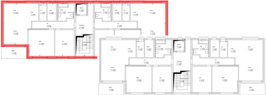
Über die Möglichkeiten der Darstellung kann entschieden werden, ob auf die Darstellung der nichttragenden Sichten komplett verzichtet wird oder nur auf die Schraffur verzichtet werden soll. Wird auf die Darstellung der nichttragenden Schichten verzichtet, wirkt sich diese Option auch auf den IFC-Export des Modells aus. Somit kann z.B. eine Sicht des Rohbaumodells vorbereitet und als Grundlage für den IFC-Export verwendet werden.
