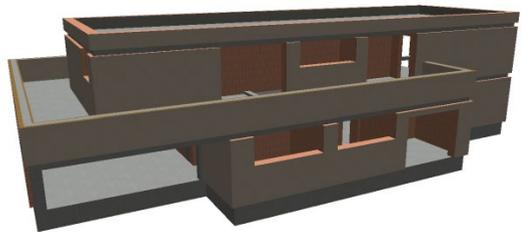
Das Rohbaumodell kann durch Eingrenzung der Sichtbarkeit, durch abwählen von Bauteil-Kategorien oder bei entsprechender Modellstruktur, durch abwählen von Geschossfolien erzeugt werden.
