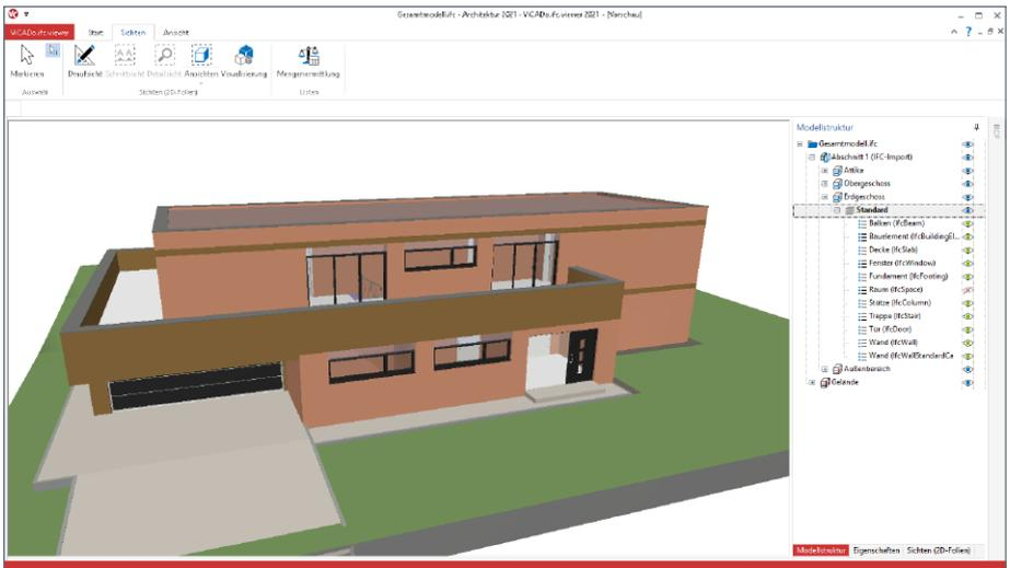
Der ViCADO.ifc.viewer kann über den ProjektManager, Register „Dokumente“ oder, wie jede andere Anwendung, über den Datei-Explorer von Windows gestartet werden. Die Steuerung der Sichtbarkeit erfolgt über das Fenster „Modellstruktur“, das auf der rechten Seite angeordnet wird.
