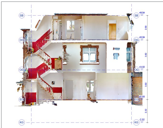
Bild 5. Punktwolke am Raster ausgerichtet
